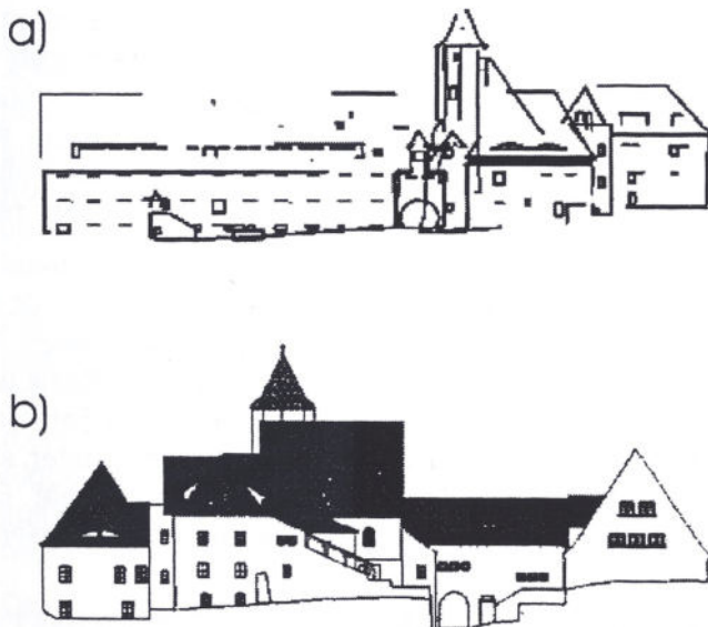
Abb. 1: Bestandsaufnahme am Schloß Jena-Lobeda, ausgeführt mit dem TRIGOMAT-System:
